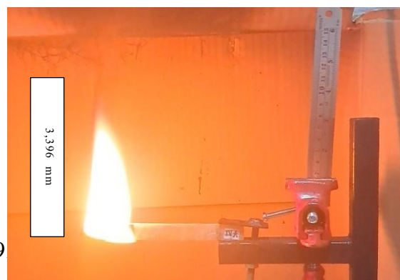
Gambar 11. Panjang Dan Tinggi Api Komposit Fraksi Volume 20%
