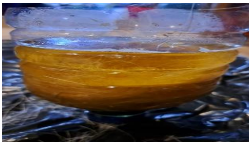
Gambar 4. Proses Alkalisasi Serat Daun Praksok
