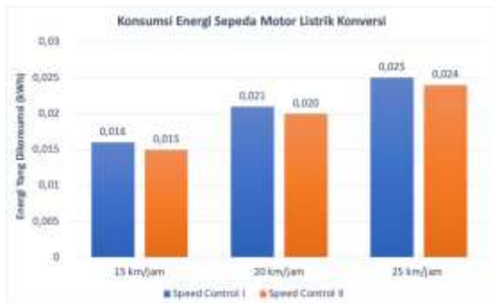
Gambar 10. Grafik Perbandingan Variasi Kecepatan dan Speed Control
