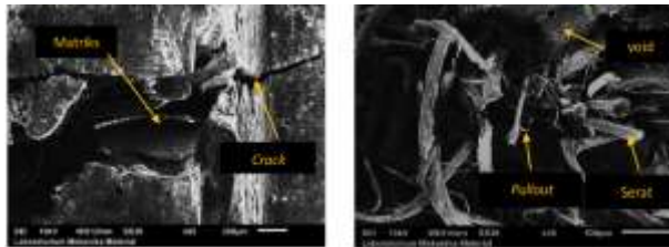
Gambar 8 SEM Komposit dengan komposisi 85% epoxy : 15% polyester
