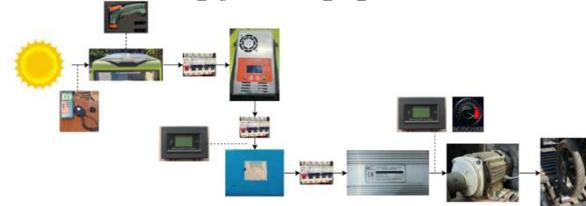
Gambar 4. Rangkaian Sistem Pengujian Charging Dan Motor Listrik
