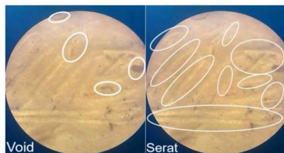
Gambar 7. Foto Mikro Fraksi Volume 7,5% Serat Daun Nanas Pembesaran 30x
