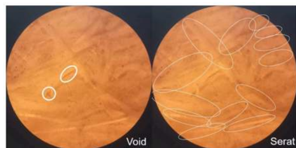
Gambar 8 Foto Mikro Fraksi Volume 10% Serat Daun Nanas Pembesaran 30x
