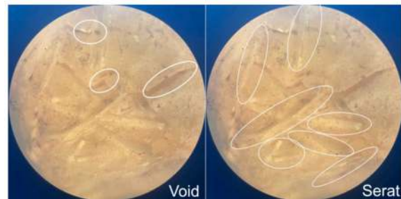
Gambar 6. Foto Mikro Fraksi Volume 5% Serat Daun Nanas Pembesaran 30x
