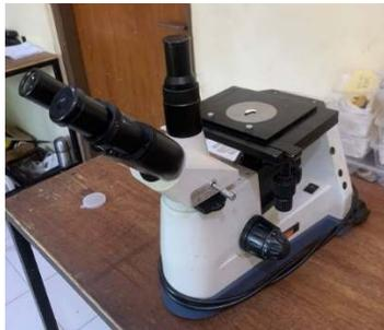
Gambar 6 Mikroskop metalurgi
