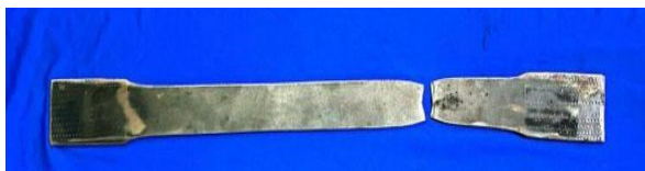
Gambar 4.2 Spesimen Uji Tarik Setelah Melakukan Pengujian
