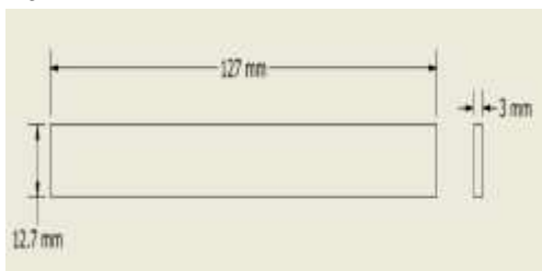
Gambar 5. Spesimen Uji Bending
