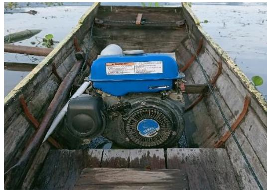
Gambar 1. Mesin Penggerak
