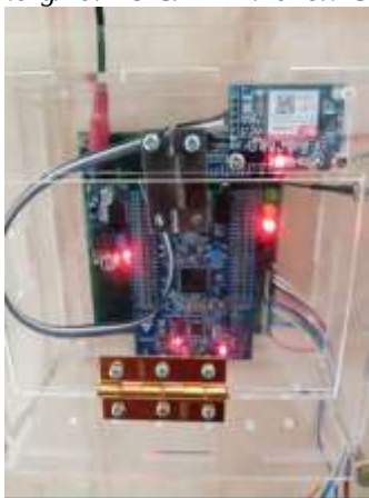
Gambar 15. Indikator Saat Mendeteksi Asap
