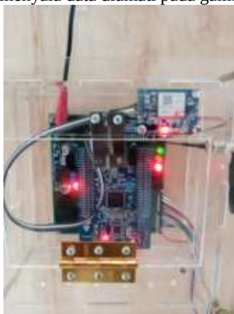
Gambar 12. Indikator Saat Mendeteksi Asap dan Suhu Melebihi Standard
