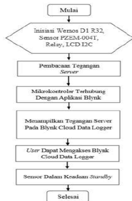
Gambar 1: Flowchart Data Logger Sistem Kontinu Suplai Daya menggunakan ATS-AMF
