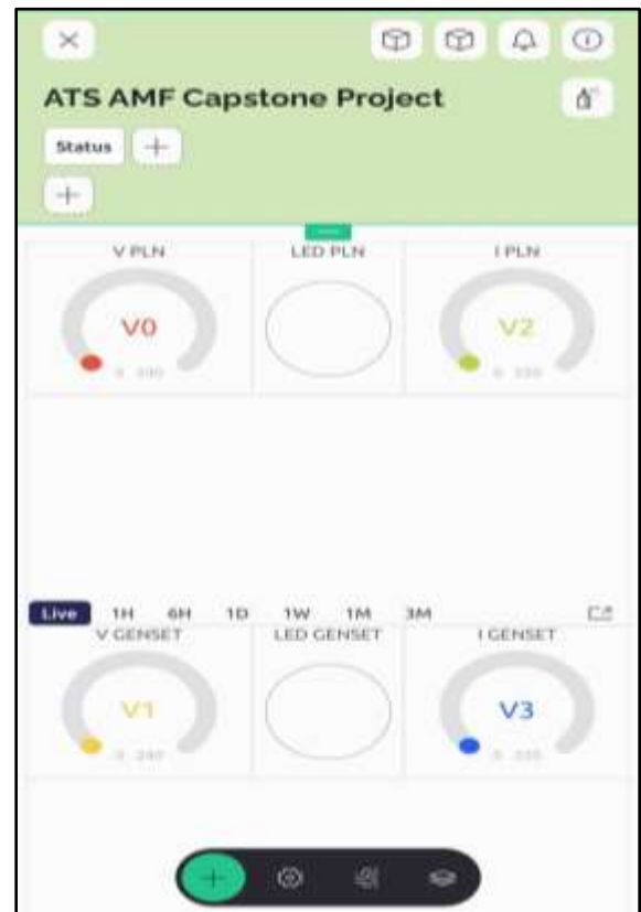
Gambar 5. Hasil Konfigurasi Widget Blynk ATS-AMF
