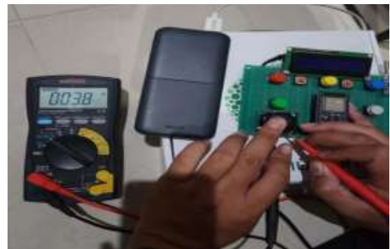
Gambar 26. Pengujian Joystick Kondisi Ditekan Sumber: Dokumen Pribadi
