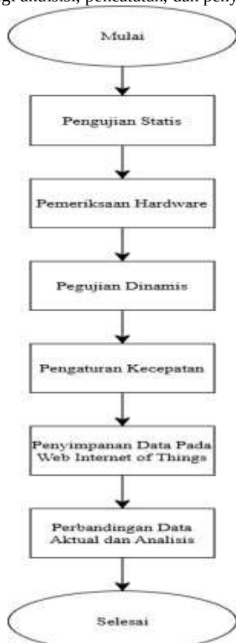
Gambar 8. Diagram Alur Pengujian Sumber: Dokumen Penelitian
