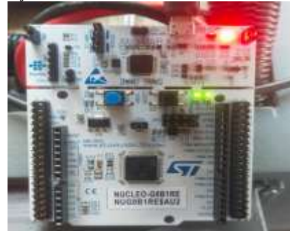
Gambar 11. Pengujian Koneksi STM32 Sumber: Dokumen Pribadi
