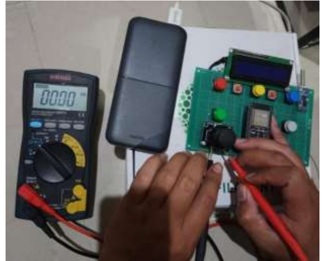
Gambar 25. Pengujian Joystick belum Ditekan Sumber: Dokumen Pribadi
