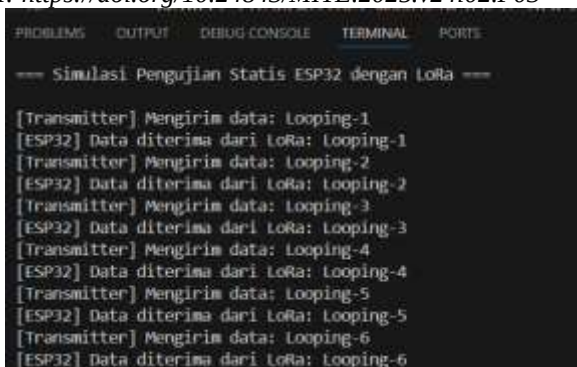
Gambar 15. Pengujian ESP32 Menerima dan Mengirim Data Sumber: Dokumen Pribadi
