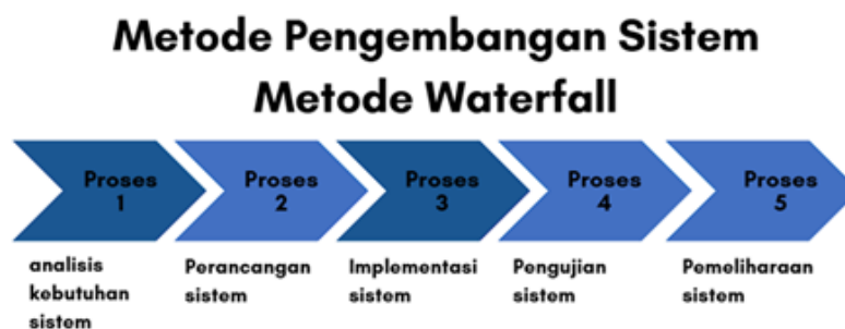
Gambar 1. Tahapan Metode Pengembangan Sistem Waterfall
