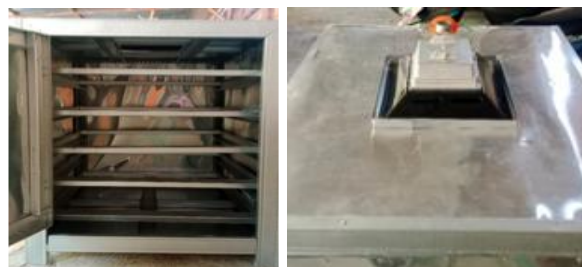
Gambar 3.2 Bagian Ruang Pengereng dan Pemanas Gasolec
