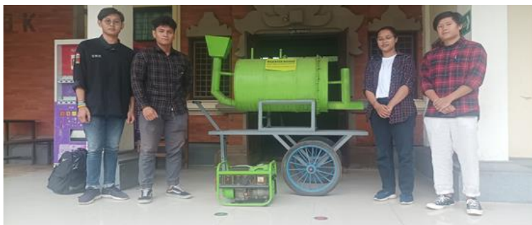
Gambar 3.1. Digester biogas portabel dilengkapi dengan genset berbahan bakar biogas
